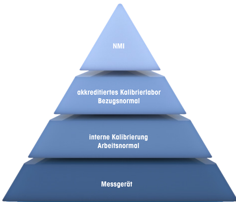
Abb. 1 Schema der Kalibrierhierarchie. Rückführung erfordert eine ununterbrochene Kette von Kalibrierungen vom Messgerät bis zu einer Referenz, meist bereitgestellt vom Nationalen Metrologieinstitut (NMI).
