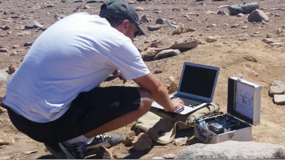
Abb. 6 Brian Stamos testet eine Bodenprobe in der Atacama-Wüste in Chile mit einem OTIC-Prototypengerät mit Niederfrequenz-Admittanz-Detektor.
