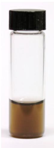
**Abb. 2** Kolloidale Suspension von hydrierten Nanodiamanten in Wasser (3 mg/mL)
