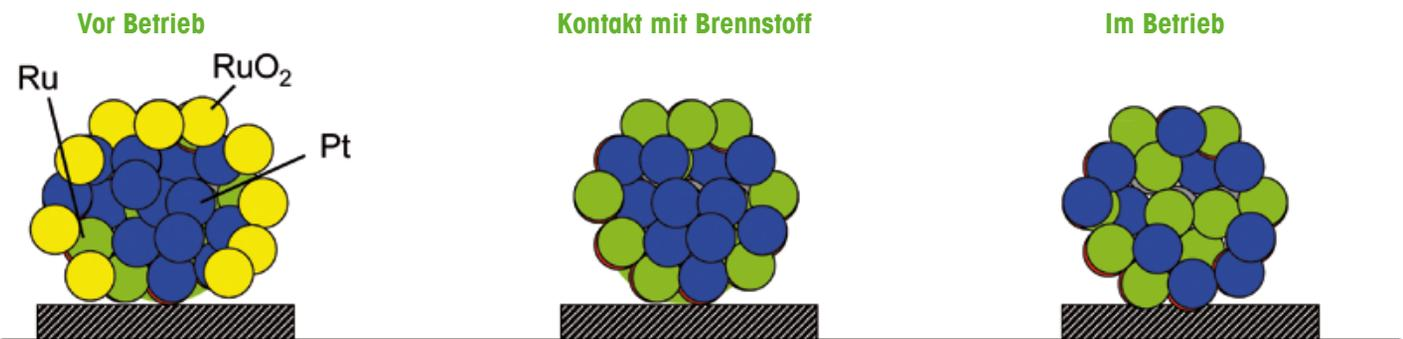
Abb. 3 Strukturänderung eines bimetallicen Pt-Ru Nanoteilchens im Betrieb
