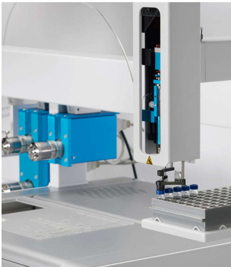
Automatisierung der LC-GC mit CTC-Sampler
