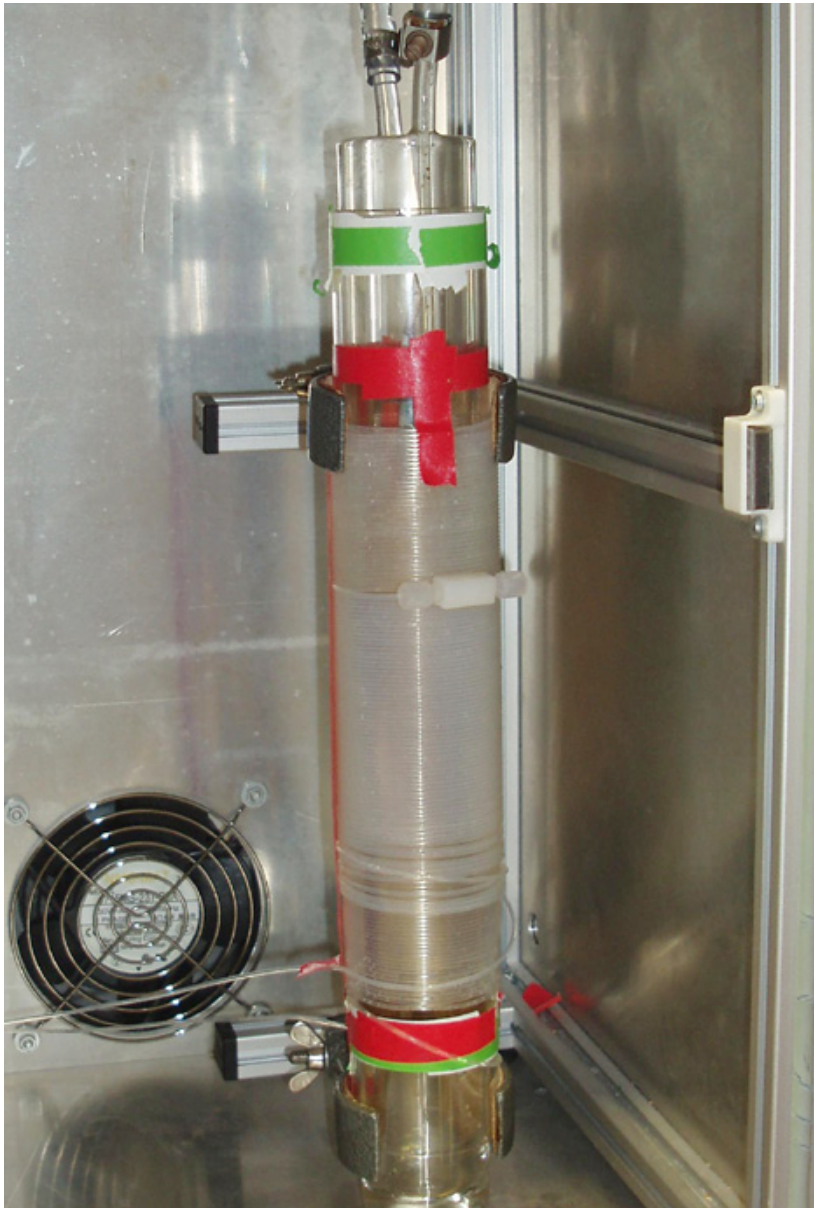
Abb. 3 Der Fotoreaktor besteht aus einem um eine gekühlte Lampe gewickelten lichtdurchlässigen Schlauch
